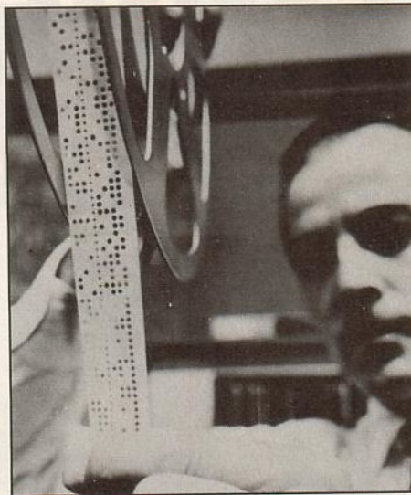
Bande perforée à sept trous et trou central de guidage.
